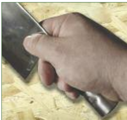
Захват с упором обуха или рукояти в головку пястной кости указательного пальца
