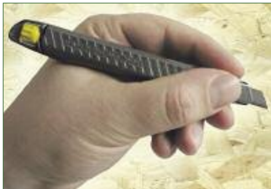
Захват с упором обуха или рукояти в головку пястной кости указательного пальца
