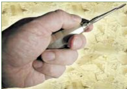
Прецизионный захват рукоятки щепотью используется на медицинских инструментах, оснащаемых гранями, для удобства позиционирования рабочей части инструмента
