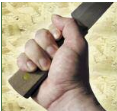
Силовой прямой захват горстью рукоятки мачете при выполнении размашистых движений по рубке растительности
