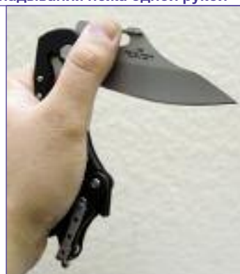
Второй способ раскладывания ножа одной рукой
