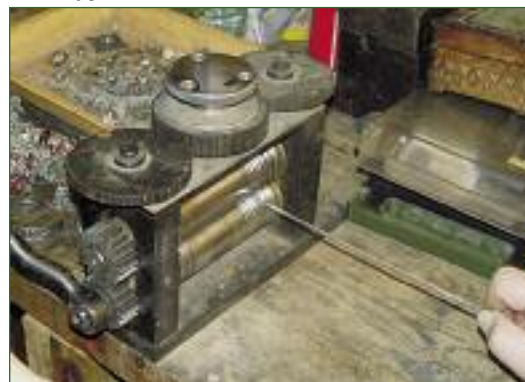
Вытягивание в вальцах серебряного прутка
