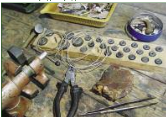
Комплект для вытяжки проволоки: набор плашек с отверстиями, тиски, воск, пассатижи
