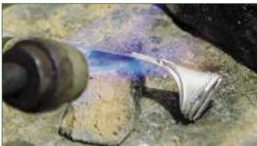
Напайка элементов филигрны на основу (обкладку рукояти)
