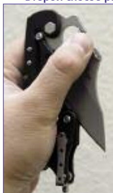
Второй способ раскладывания ножа одной рукой
