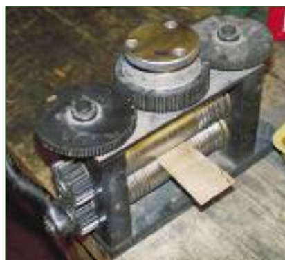
Изготовление тонкой серебряной пластины
