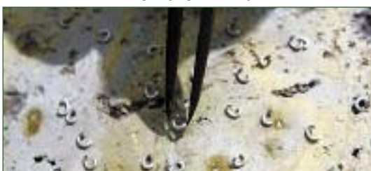
Укладывание серебряных колец на огнеупорную поверхность
