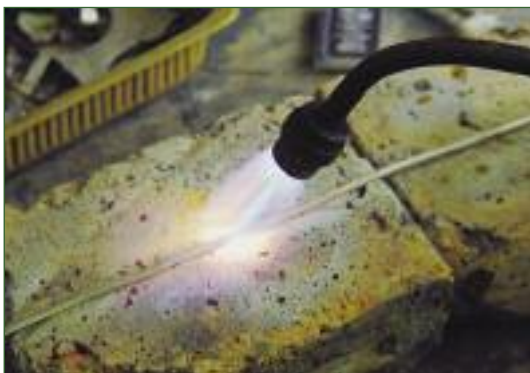
Отжиг серебряной проволоки перед очередным этапом вытяжки
