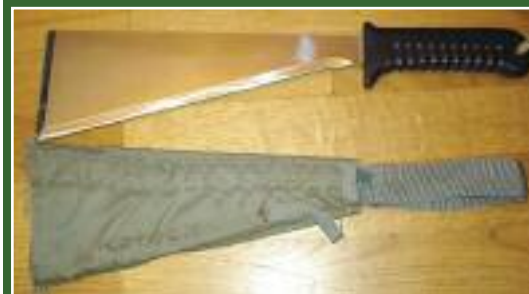
Мачете, входящее в «космический» НАЗ, может использоваться в качестве приклада для комбинированного пистолета ТП-82
