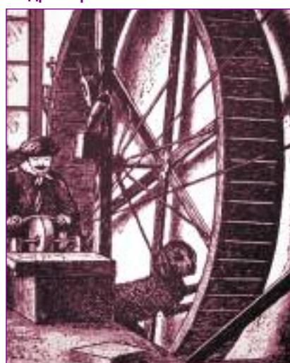
Шлифовальный станок, двигателем которого выступала специально дрессированная собака
