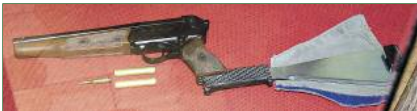
Мачете, входящее в «космический» НАЗ, может использоваться в качестве приклада для комбинированного пистолета ТП-82
