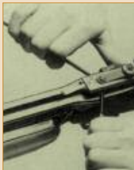
Алгоритм натяжения тетивы, взведения арбалета с помощью рук и выключения предохранителя перед выстрелом
