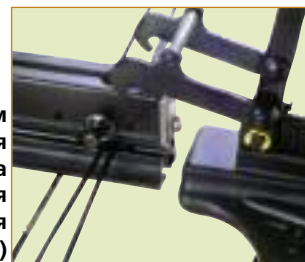
Механизм соединения ложи и лука (разборная конструкция арбалета)
