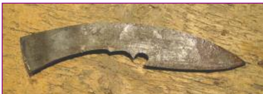
Обтачиваем заготовку «на грубую» форму ножа
