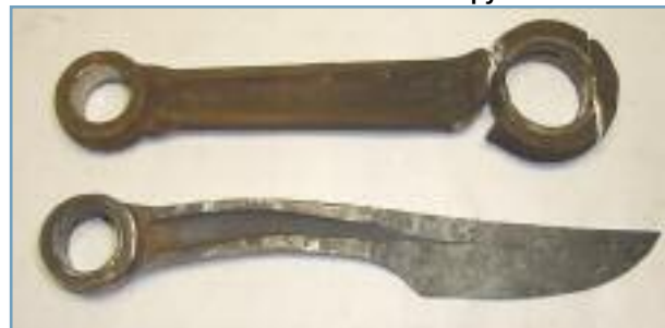
Торцуем на точиле боковые поверхности и ровняем весь нож
