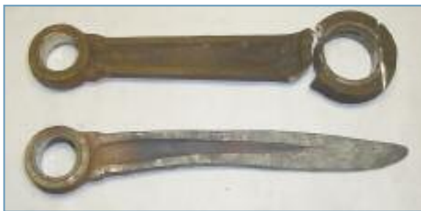
Оттягиваем заготовку под будущий клинок
