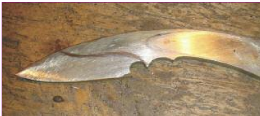
Делаем разметку спусков под заточку и под накладки на рукоять
