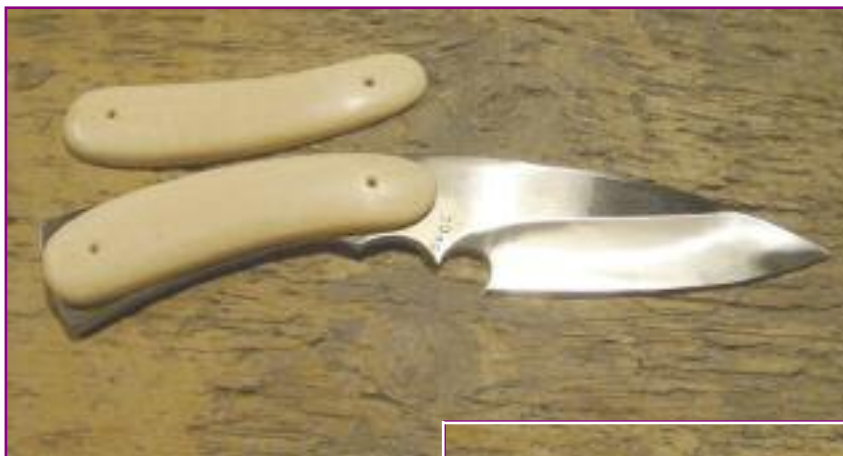
Готовые накладки примеряем на рукоять и просверливаем в них отверстия соосно с заготовкой
