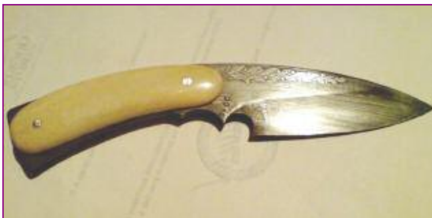
Приклепываем накладки на протравленный дамасский клинок (кузнец Красин Михаил)
