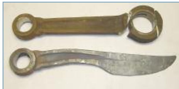
Оттягиваем сам клинок и изгибаем рукоять
