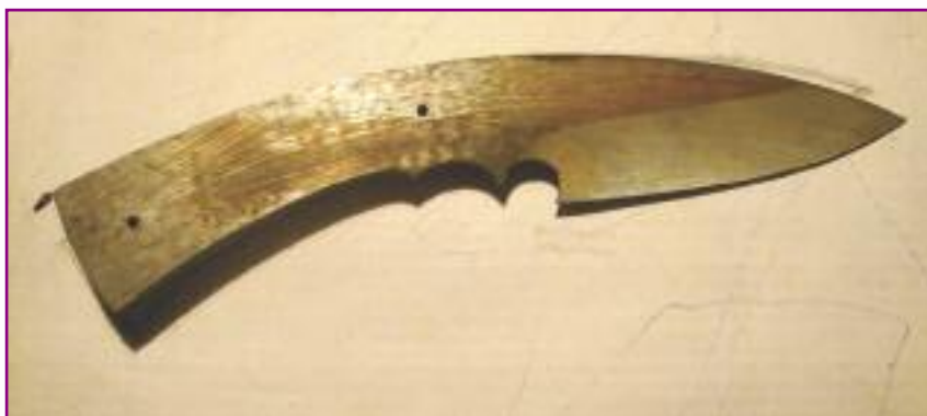
Делаем спуски под заточку (выборку) просверливаем отверстия под заклепки
