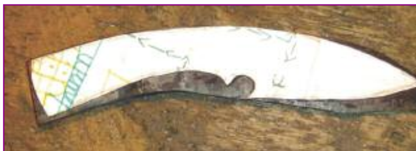
Вырезаем шаблон из бумаги и клеем ПВА приклеиваем к заготовке
