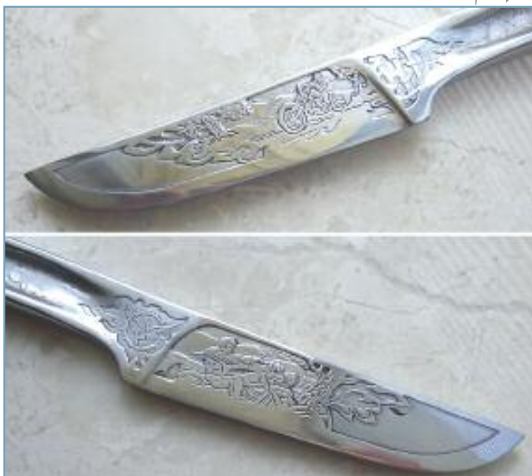
Далее начисто шлифуем, при необходимости полируем и затачиваем
