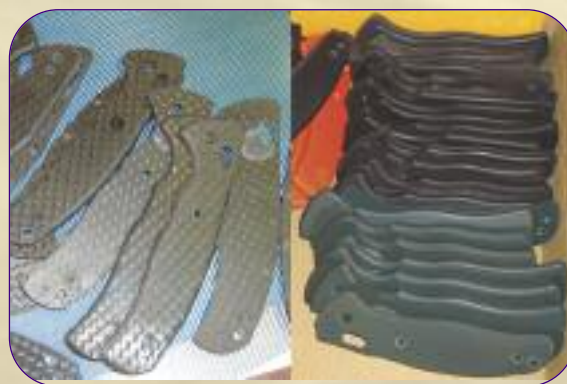
Накладки рукоятей: дерево, карбонфибра, стеклотекстолит G10
