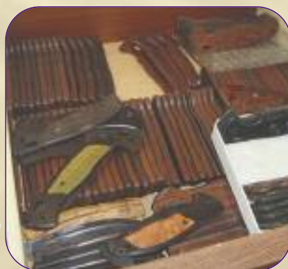
Накладки рукоятей: дерево, карбонфибра, стеклотекстолит G10
