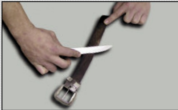
Схема доводки режущей кромки на кожаном ремне. Движение клинка осуществляется обухом вперед
