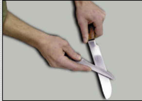
Использование обуха другого ножа в качестве мусата для выпрямления режущей кромки
