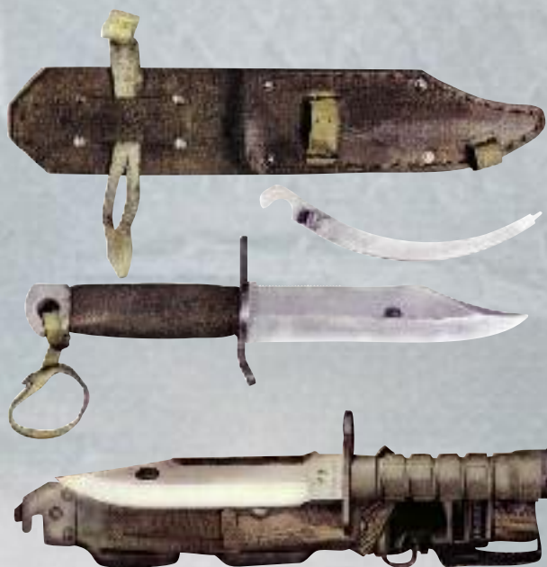
Нож морских разведчиков конструкции Р.М. Тодорова общая длина 246 мм длина клинка 140 мм ширина клинка 30 мм
