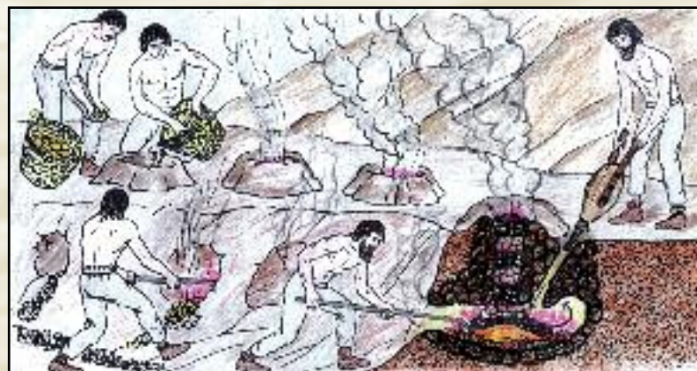
Процес отримання заліза у заглибленій шахтній печі без шлаковипуску
