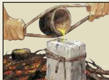
Заливка расплавленной бронзы в форму
