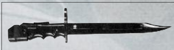
Английский штык-нож №5 МК I (обр. 1945 г.) общая длина 310 мм длина клинка 200 мм ширина клинка 24 мм
