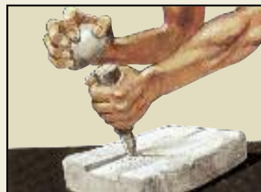
Изготовление закрытой литейной формы
