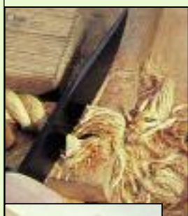
Magnum Tanto II (San Mai): длина общ. — 334 мм, длина клинка — 194 мм, ширина — 28 мм, толщина в обухе — 4,7 мм, стальная гарда, кожаные ножны
