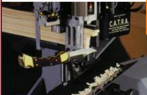
Для проверки качества изготовления и заточки клинков используется компьютеризированная установка C.A.T.R.A.
